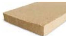
Fibra di legno **prodotta a secco** densità 50 kg/m<sup>3</sup> | Conduttività termica dichiarata  $\lambda_b$ [W/(m\*k)] 0,038 | Calore specifico c 2.100 J/kg K
