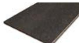
Fibra di legno **prodotta a umido** densità 260 kg/m<sup>3</sup> | Conduttività termica dichiarata  $\lambda_D$ [W/(m\*k)] 0,050 | Calore specifico c 2.100 J/kg K
