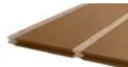
Fibra di legno **prodotta a umido** densità 160 kg/m<sup>3</sup> | Conduttività termica dichiarata  $\lambda_D$ [W/(m\*k)] 0,039 | Calore specifico c 2.100 J/kg K
