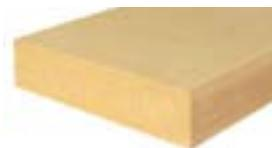
Fibra di legno **prodotta a secco** densità 140 kg/m<sup>3</sup> | Conduttività termica dichiarata  $\lambda_D$ [W/(m\*k)] 0,041 | Calore specifico c 2.100 J/kg K
