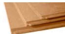
Fibra di legno **prodotta a secco** spessori da 52 a 100 mm densità 180 kg/m<sup>3</sup> | Conduttività termica dichiarata  $\lambda_D$ [W/(m\*k)] 0,043
