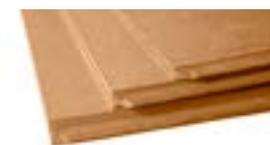
Fibra di legno **prodotta a umido** densità 270 kg/m<sup>3</sup> | Conduttività termica dichiarata  $\lambda_D$ [W/(m\*k)] 0,048 | Calore specifico c 2.100 J/kg K
