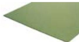
Fibra di legno **prodotta a umido** densità 250 kg/m<sup>3</sup> | Conduttività termica dichiarata  $\lambda_D$ [W/(m\*k)] 0,070 | Calore specifico c 2.100 J/kg K
