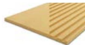
Fibra di legno **prodotta a secco** densità 140 kg/m<sup>3</sup> | Conduttività termica dichiarata  $\lambda_D$ [W/(m\*k)] 0,041 | Calore specifico c 2.100 J/kg K
