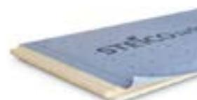
Fibra di legno **prodotta a secco** spessore 40 mm densità 210 kg/m<sup>3</sup> | Conduttività termica dichiarata  $\lambda_D$ [W/(m\*k)] 0,045
