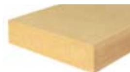
Fibra di legno **prodotta a secco** densità 110 kg/m<sup>3</sup> | Conduttività termica dichiarata  $\lambda_0$ [W/(m\*k)] 0,037 | Calore specifico c 2.100 J/kg K
