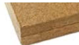
Fibra di legno **prodotta a umido** densità 160 kg/m<sup>3</sup> | Conduttività termica dichiarata  $\lambda_D$ [W/(m\*k)] 0,039 | Calore specifico c 2.100 J/kg K
