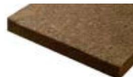
Fibra di legno **prodotta a umido** densità 230 kg/m<sup>3</sup> | Conduttività termica dichiarata  $\lambda_D$ [W/(m\*k)] 0,055 | Calore specifico c 2.100 J/kg K
