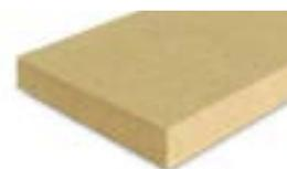
Fibra di legno **prodotta a secco** densità 60 kg/m<sup>3</sup> | Conduttività termica dichiarata  $\lambda_b$ [W/(m\*k)] 0,036 | Calore specifico c 2.100 J/kg K
