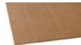
Fibra di legno **prodotta a umido** densità 250 kg/m<sup>3</sup> | Conduttività termica dichiarata  $\lambda_D$ [W/(m\*k)] 0,048 | Calore specifico c 2.100 J/kg K
