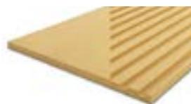
Pannello in fibra di legno densità 140 kg/m<sup>3</sup> | Conduttività termica dichiarata  $\lambda_D$ [W/(m\*k)] 0,041 | Calore specifico c 2.100 J/kg K
