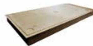
Pannello in sughero biondo densità 150+160 kg/m<sup>3</sup> | Conduttività termica dichiarata  $\lambda_D$ [W/(m\*k)] 0,041 | Calore specifico c 1.674 J/kg K
