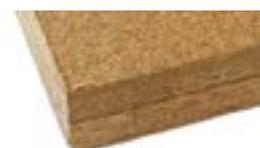
Pannello in fibra di legno densità 160 kg/m<sup>3</sup> | Conduttività termica dichiarata  $\lambda_D$ [W/(m\*k)] 0,039 | Calore specifico c 2.100 J/kg K
