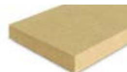
Pannello in fibra di legno densità 60 kg/m<sup>3</sup> | Conduttività termica dichiarata  $\lambda_D$ [W/(m\*k)] 0,036 | Calore specifico c 2.100 J/kg K
