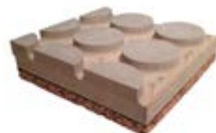
Pannello in sughero biondo densità 150+160 kg/m<sup>3</sup> | Conduttività termica dichiarata  $\lambda_D$ [W/(m\*k)] 0,041 | Calore specifico c 1.674 J/kg K
