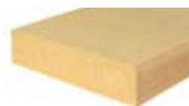
Pannello in fibra di legno densità 110 kg/m<sup>3</sup> | Conduttività termica dichiarata  $\lambda_D$ [W/(m\*k)] 0,037 | Calore specifico c 2.100 J/kg K
