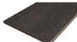
Pannello in fibra di legno densità 260 kg/m<sup>3</sup> | Conduttività termica dichiarata  $\lambda_b$ [W/(m\*k)] 0,050 | Calore specifico c 2.100 J/kg K
