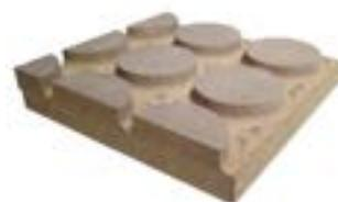
Pannello in cemento legno densità 1350 kg/m<sup>3</sup> | Conduttività termica dichiarata  $\lambda_D$ [W/(m\*k)] 0,26 | Calore specifico c 1.880 J/kg K
