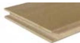
Fibra di legno densità 240 kg/m<sup>3</sup> | Conduttività termica dichiarata  $\lambda_D$ [W/(m\*k)] 0,046 | Calore specifico c 2.100 J/kg K
