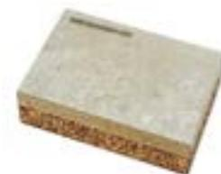
Sughero biondo densità 150+160 kg/m<sup>3</sup> | Conduttività termica dichiarata  $\lambda_D$ [W/(m\*k)] 0,041 | Calore specifico c 1.674 J/kg K
