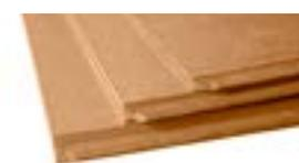
Pannello in fibra di legno densità 270 kg/m<sup>3</sup> | Conduttività termica dichiarata  $\lambda_b$ [W/(m\*k)] 0,048 | Calore specifico c 2.100 J/kg K
