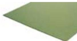
Pannello in fibra di legno densità 250 kg/m<sup>3</sup> | Conduttività termica dichiarata  $\lambda_b$ [W/(m\*k)] 0,070 | Calore specifico c 2.100 J/kg K
