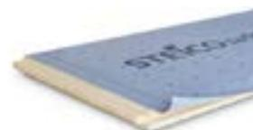
Fibra di legno spessore 40 mm densità 210 kg/m<sup>3</sup> | Conduttività termica dichiarata  $\lambda_D$ [W/(m\*k)] 0,045
