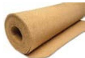
Rotolo in sughero biondo densità 150÷160 kg/m<sup>3</sup> | Conduttività termica dichiarata  $\lambda_D$ [W/(m\*k)] 0,041 | Calore specifico c 1.674 J/kg K
