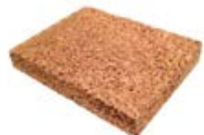
Pannello in sughero biondo densità 150÷160 kg/m<sup>3</sup> | Conduttività termica dichiarata  $\lambda_D$ [W/(m\*k)] 0,041 | Calore specifico c 1.674 J/kg K
